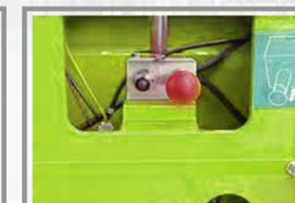
**Válvula de liberación manual:** Permite mover la máquina manualmente cuando no puede desplazarse por sí misma.
