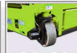
**Motor de tracción:** Proporciona el movimiento de la máquina.
