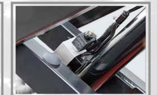
**Válvula a prueba de explosiones:** Previene la caída de la máquina en caso de fuga en la tubería de aceite.
