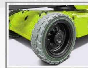
Neumáticos: neumáticos rellenos de espuma con buen rendimiento fuera de carretera
