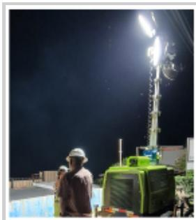
Alta capacidad de iluminación con 4000 watts en haluro metálico
