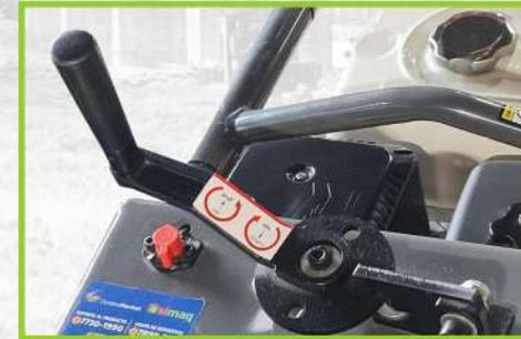
Manivela de regulación de nivelación de corte
