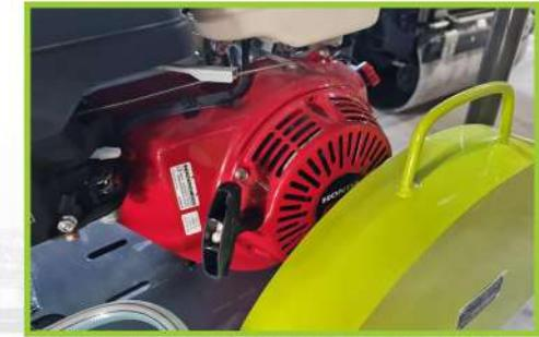
Motor Honda GX390 de 13HP asegurando accesibilidad de repuestos
