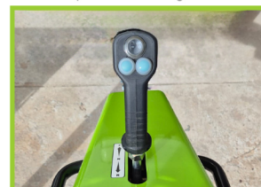
Marcha hacia adelante/hacia atrás, dirección izquierda/derecha y vibración, todo ello controlado por la palanca de control integrada
