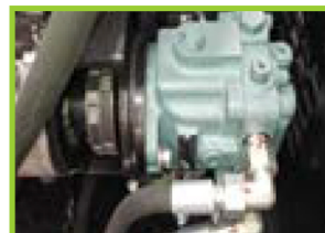
La bomba de émbolo variable Danfoss importada impulsa la máquina a velocidad continua
