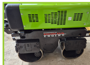
Los motores hidráulicos cicloides dobles de la marca americana impulsan la máquina caminando
